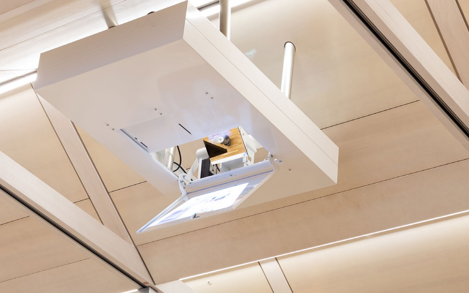
Einer der vier Laser Projektoren mit speziell angepasstem Spiegelsystem.
